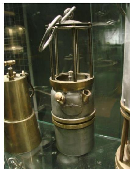
Lampenausstellung mit trichterförmigen Brennerreflektor bei der Karbidlampe (Bild rechts, 2te Lampe von rechts unten) Links: ARRAS-Lampe ohne Glas, ähnlich der Decazeville – Lampe.
