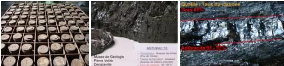
Hierbei handelt es sich um "Probendöschen". Von den vollen Lohren wurden Proben genommen, in diese Dosen verpackt und anschließend im Labor untersucht.
