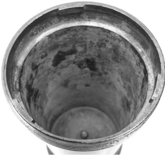
Batterietopf mit drei Befestigungsmöglichkeiten
