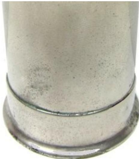
Verstärkungsring am Akkugehäuseboden
