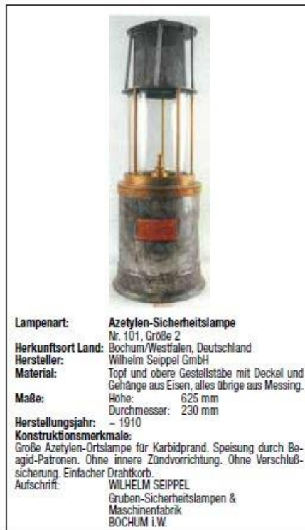
7 Azetylen-Sicherheitslampe Nr. 101, Größe 2, Bauart Wilhelm Seippel GmbH
