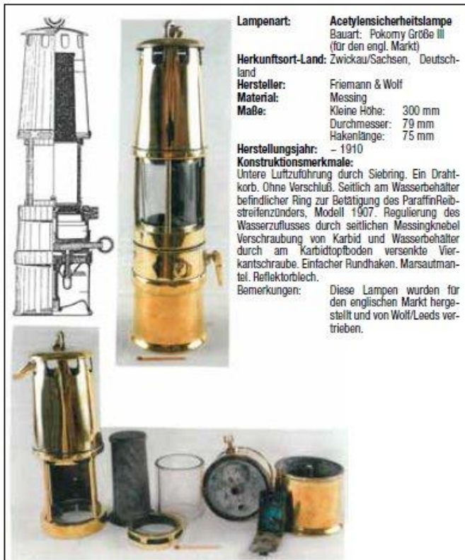
5 Acetylen-Sicherheitslampe, Größe III, Bauart: Pokorny
