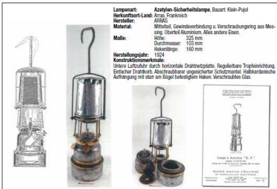
10 Azetylen-Sicherheitslampe, Bauart Klein-Pujol
