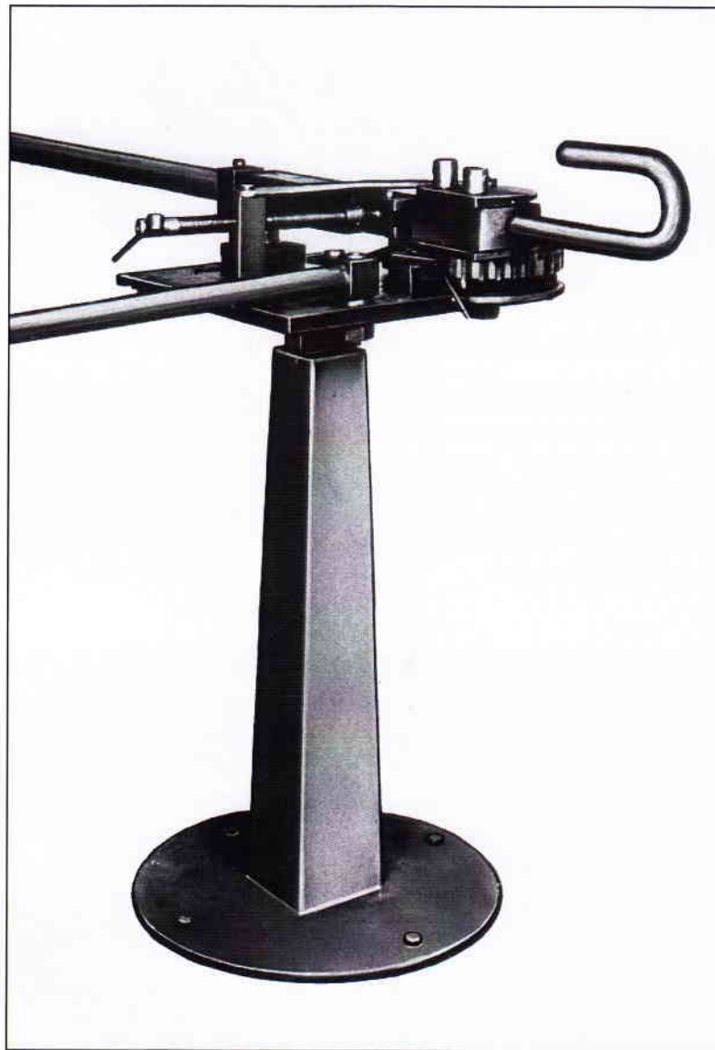
Abbildung einer Rohrbiegemaschine, die zur Produktpalette der Firma Hermann Knipp gehörte. Damit wurden u. a. Rohre für Rohrmöbel und Gepäckträger von Postfahrrädern hergestellt
