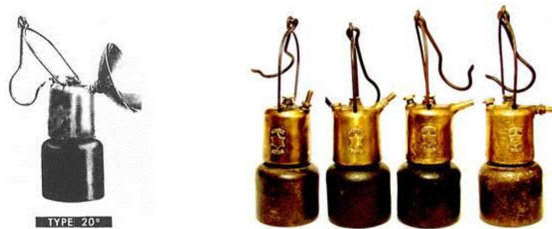
Hier die 20 Grad - Lampe im Vergleich zu den anderen Bauformen.
