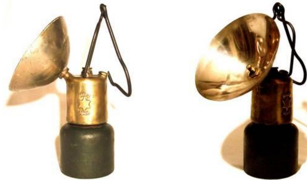
Type K / 45 Grad - seitlicher 45 Grad Brenneransatz (Dieses Modell gibt es auch in einer 20 Grad Ausführung)
