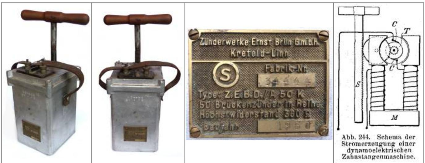
Auf der Vorderseite befindet sich ein Metallschild mit der Aufschrift: „Zünderwerke Ernst Brün G.m.b.H. Krefeld - Linn. Ein „S“ im Kreis (steht für Schlagwettersicherheit) Fabrik Nr. 34444 Type Z.E.E.B./A 50 K. 50 Brückenzünder in Reihe Höchstwiderstand 360 OHM Baujahr 1950“
