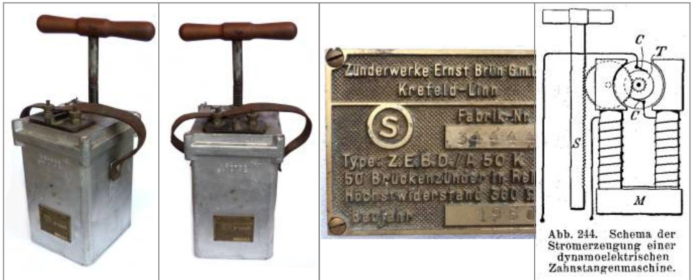
Auf der Vorderseite befindet sich ein Metallschild mit der Aufschrift: „Zünderwerke Ernst Brün G.m.b.H. Krefeld – Linn. Ein „S“ im Kreis (steht für Schlagwettersicherheit) Fabrik Nr. 34444 Type Z.EE.B.D/A 50 K. 50 Brückenzünder in Reihe Höchstwiderstand 360 OHM Baujahr 1950
