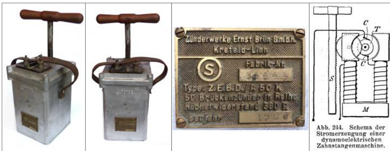
Auf der Vorderseite befindet sich ein Metallschild mit der Aufschrift: „Zünderwerke Ernst Brün G.m.b.H. Krefeld – Linn. Ein „S“ im Kreis (steht für Schlagwettersicherheit) Fabrik Nr. 34444 Type Z.E.E.B.D/A 50 K. 50 Brückenzündst. in Reihe Höchstwiderstand 360 OHM Baujahr 1950
