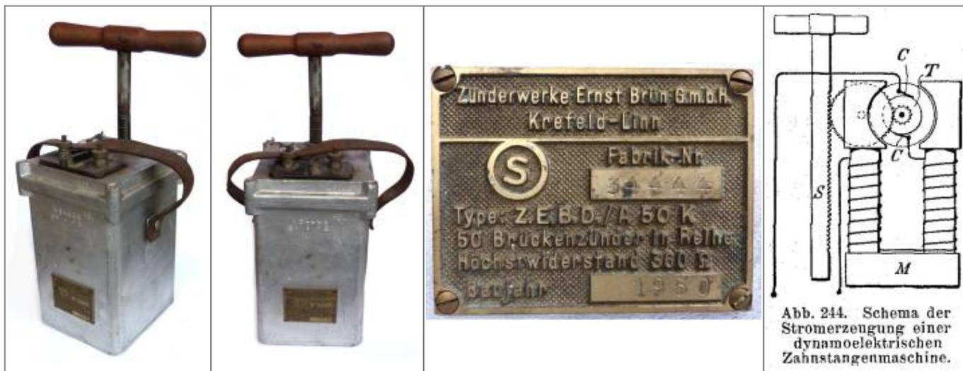
Auf der Vorderseite befindet sich ein Metallschild mit der Aufschrift: „Zünderwerke Ernst Brün G.m.b.H. Krefeld – Linn. Ein „S“ im Kreis (steht für Schlagwettersicherheit) Fabrik Nr. 34444 Type Z.E.E.B.D/A 50 K. 50 Brückenzündler in Reihe Höchstwiderstand 360 OHM Baujahr 1950
