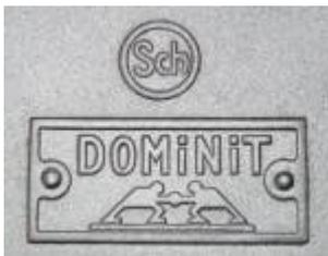
**Blitzer** mit aufgenietetem Dominit Schild und das alte Zeichen für **Schlagwetter - schutz** (Sch im Kreis). Verschluss durch Dreikantschraube, Stahlblech vernickelt. Zeitlich ca. 1935- 1940.
