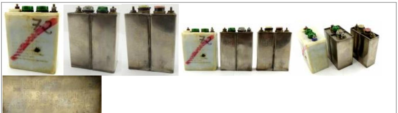
Glühlampe : 2,5V - 0,5A - Schraubsockel E 10 (wie Fahrradglühlampe). Akku : DTN 4.5 2,6V, 4,5Ah - Ladestrom 1,2A - Ladedauer 7 Stunden. Die Leuchtdauer müsste so bei 8h gelegen haben.
