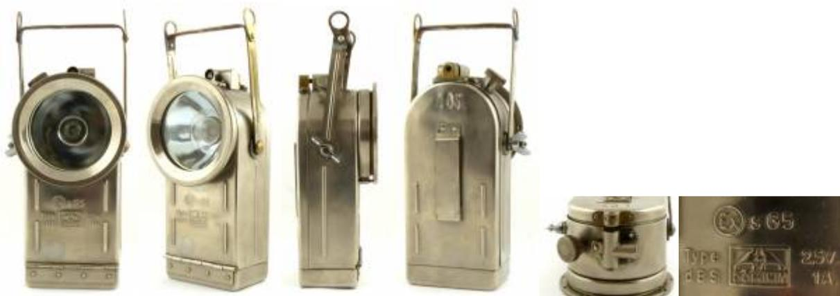
(sG5 - Bezeichnung des Explosionsschutzes. Bereiche bzw. Gasmisch- und Explosionsklassen für die diese Lampe zugelassen war)
