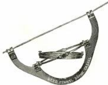
Fig. 105. Ansicht des Casseler Hängekompasses. (1/4 der natürl. Größe.)
