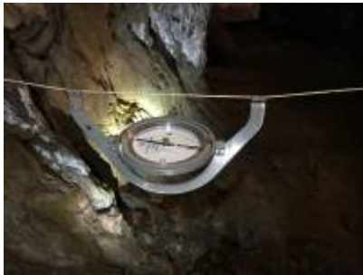
Fig. 105. Ansicht des Casseler Hängekompasses. (1/4 der natürl. Größe.)
