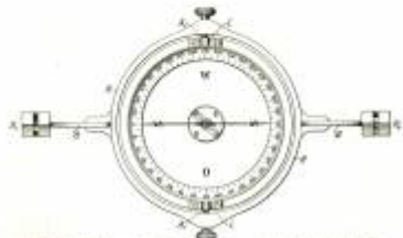
Fig. 106. Hängekompass nach Friedrich Simon. (1/2 der natürl. Größe.)
