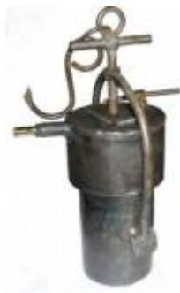
Karbidlampe mit seitlich verlegtem "Wasser-Verteil-Rohr"
