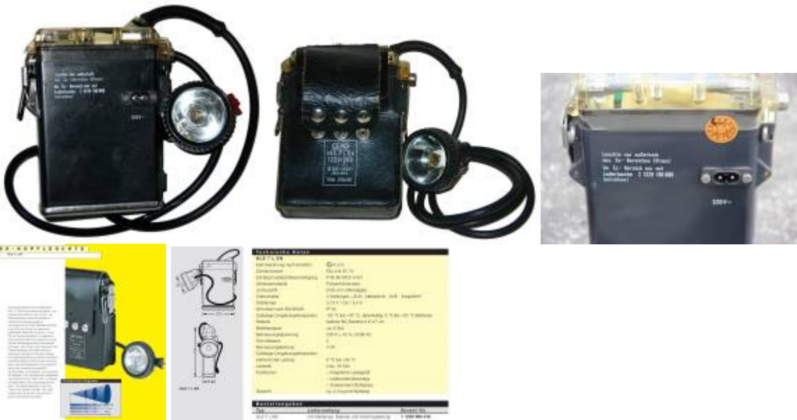
Akku: NiCd (Trockenbatterie, ohne flüssiges Elektrolyt) 3,75 V, Glühlampe: 3,75 V, 0,8/0,4 A, 7 AH, Ladespannung 230V, Höhe: 200mm, Breite: 150mm, Tiefe: 55mm, Gewicht: 2000 gr., mit Anschlusskabel für 220 Volt.
