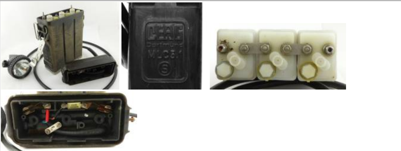
Akku: NiCd (dreizellig) 3,90 V, Glühlampe: 3,75 V, 1,0/0,5 A, Ladespannung 5,1V, 14 Ah, Höhe: 194mm, Breite: 133mm, Tiefe: 54mm, Gewicht: 2300 gr.
