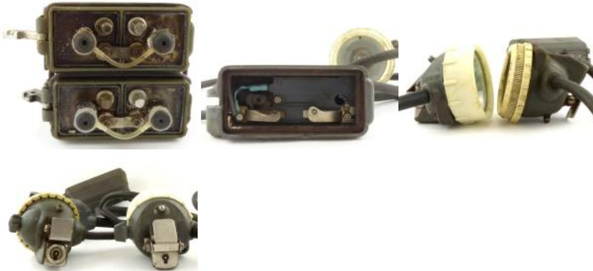
FRIWO-Kopfstücke: Das neuere Kopfstück ist mit dem breiteren weißen Rand und den größeren Schalter versehen. Akku: NiCd (zweizellig) 2,6 V, Glühlampe: 2,5 V, 1,0/0,5 A, Höhe: 171mm, Breite: 115mm, Tiefe: 49mm, Gewicht: 1910 gr.
