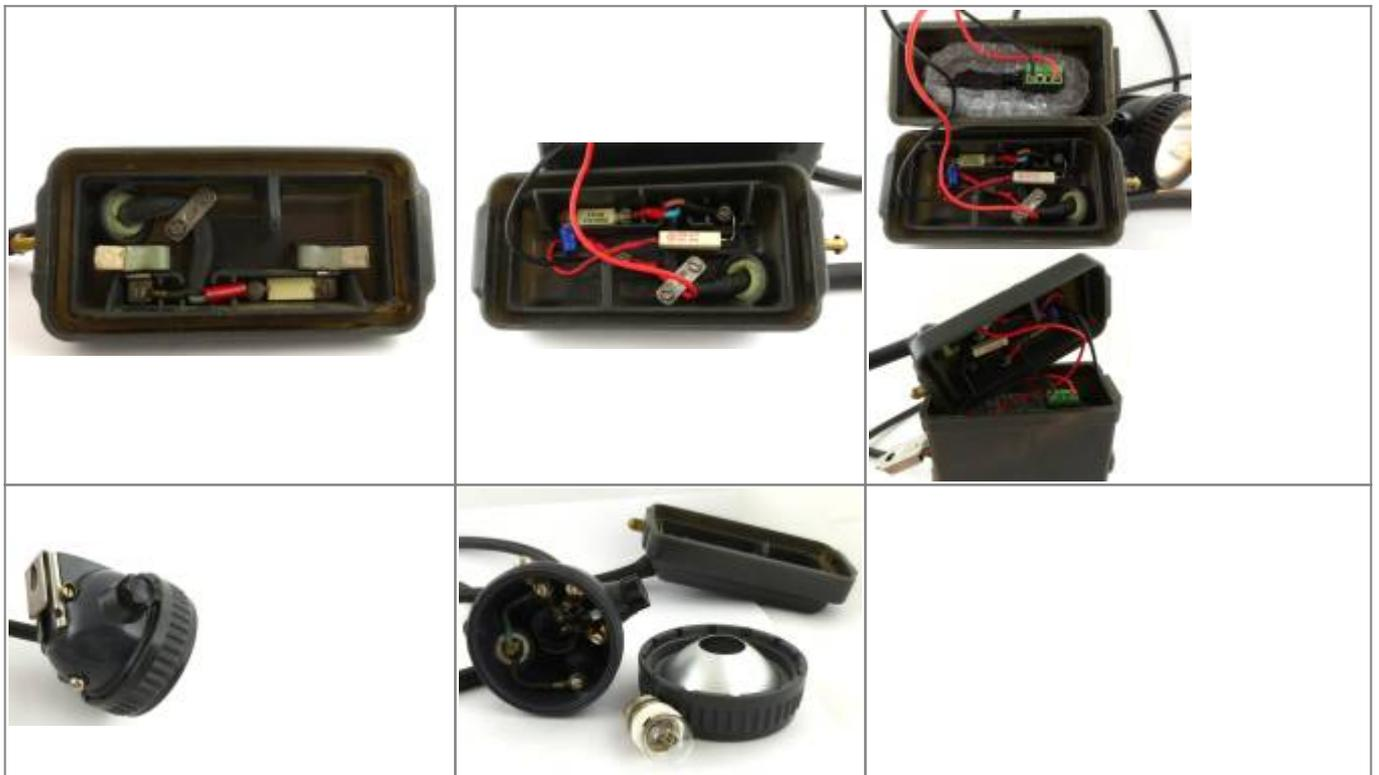
Für den einfachen Umbau mit einer Powerbank als Energiequelle ist hier ein Keramik-Widerstand mit 1,5 Ohm (10W) eingebaut worden. Dadurch reduziert sich die Spannung von 5 Volt auf 3,5
