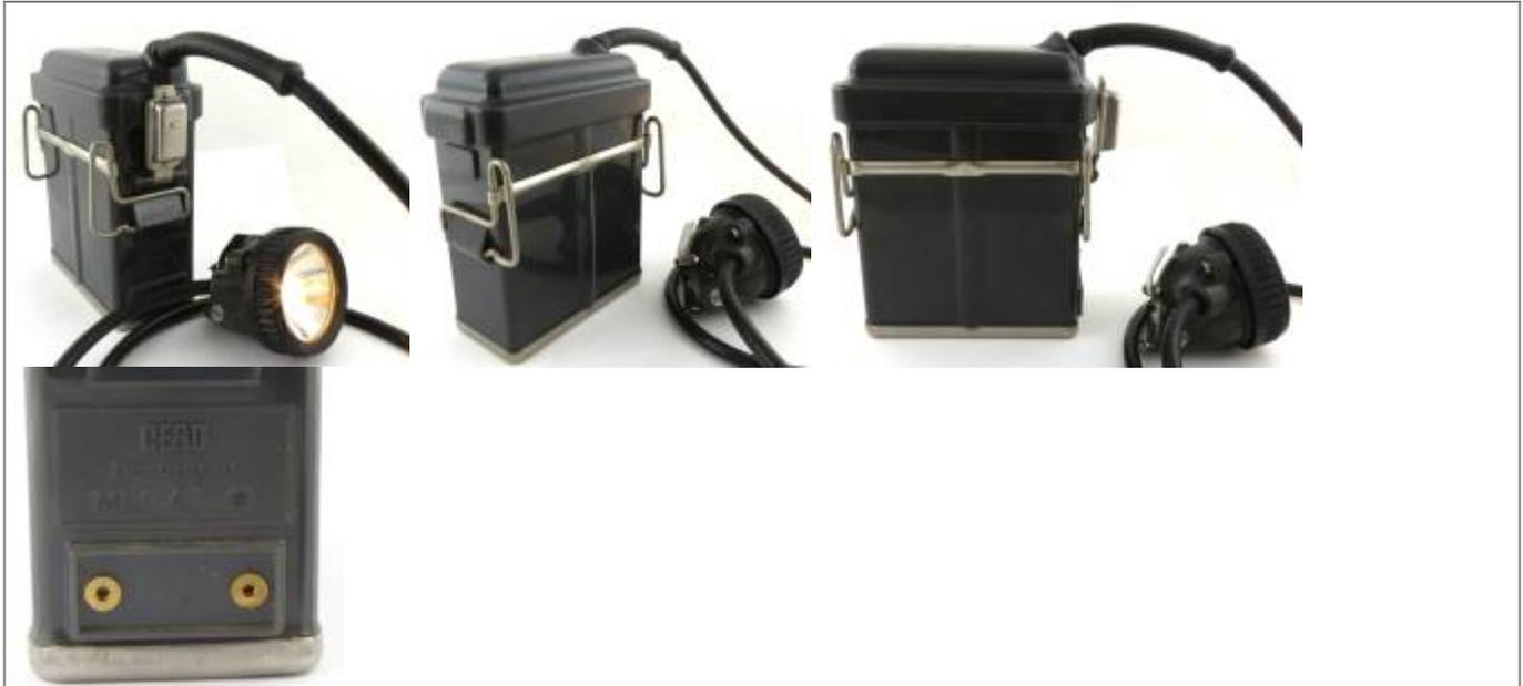
Akku: NiCd (dreizellig) 3,90 V, Glühlampe: 3,75 V, 1,0/0,5 A, 11 Ah, Ladespannung 5V, Höhe: 160mm, Breite: 121mm, Tiefe: 56mm, Gewicht: 2000 gr.
