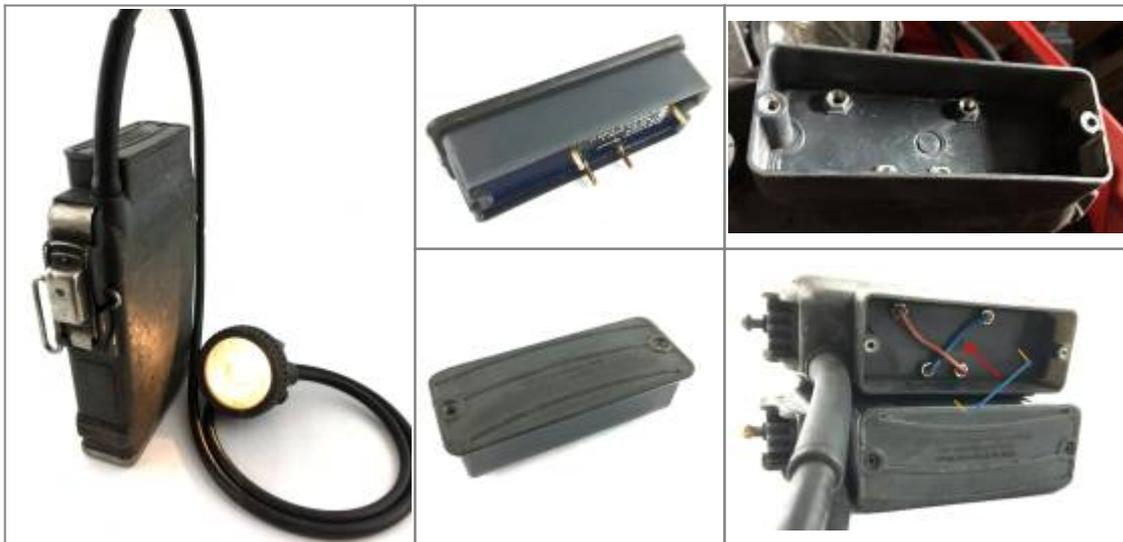
Problem 2: Im Inneren der CEAG 9.2 befindet sich der Nickel-Cadmium-Nasszellenakkumulator, der die Energie für die Kopfleuchte und den Personenkennbaustein liefert. Auch im Ruhezustand verbraucht der Personenkennbaustein Energie und **entläd bei längerem Nichtgebrauch** den Akku. Durch entfernen einer Schraube im Kopfteil soll dies angeblich verhindert werden (Noch in der Testphase!). Hier schon mal zum Ausprobieren eine Anleitung.
