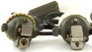
FRIWO-Kopfstücke: Das neuere Kopfstück ist mit dem breiteren weißen Rand und den größeren Schalter versehen. Akku: NiCd (zweizellig) 2,6 V, Glühlampe: 2,5 V, 1,0/0,5 A, Höhe: 171mm, Breite: 115mm, Tiefe: 49mm, Gewicht: 1910 gr.
