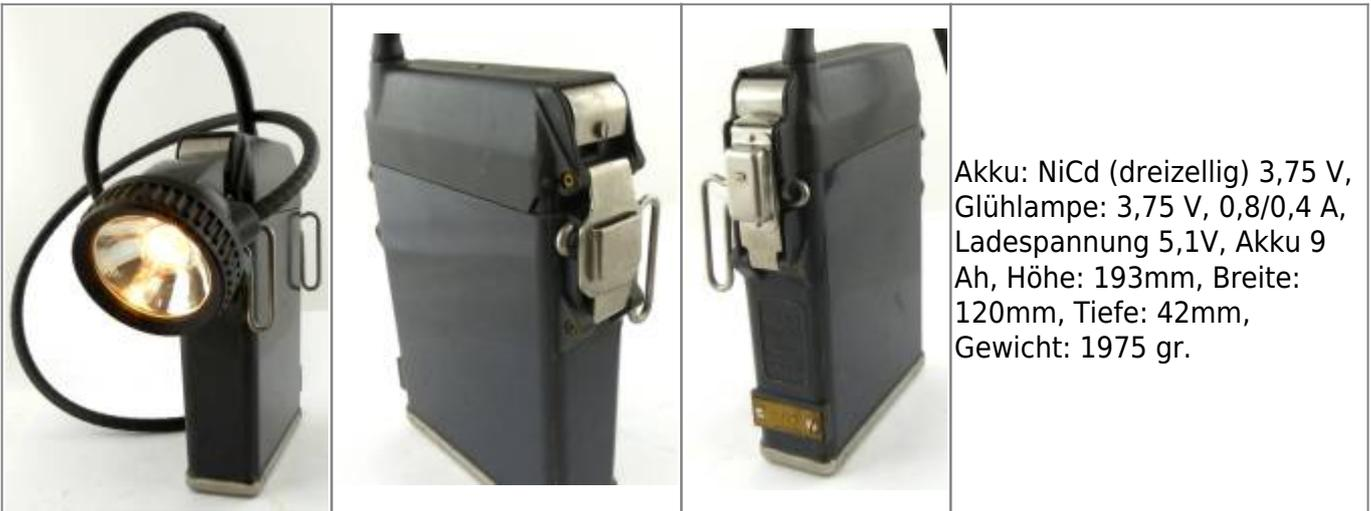
Akku: NiCd (dreizellig) 3,75 V, Glühlampe: 3,75 V, 0,8/0,4 A, Ladespannung 5,1V, Akku 9 Ah, Höhe: 193mm, Breite: 120mm, Tiefe: 42mm, Gewicht: 1975 gr.
