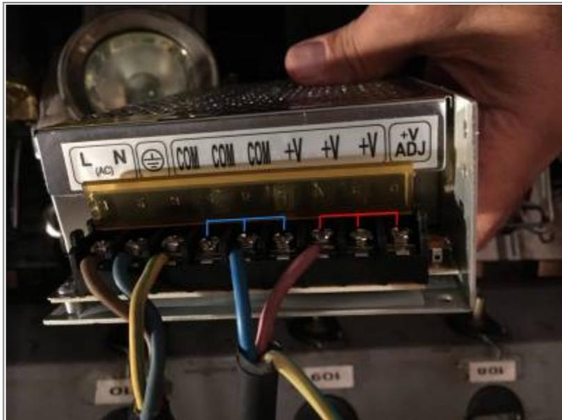
Mit diesem Netzteil ist es möglich einige Steckplätze einer Ladestation zu betreiben, z.B. 5V 40A 200W LED Power Supply Netzteil 230V. (Plus ans Blech anschließen. !Probieren!) Ohne Gewähr—Soll auch mit einem alten PC - Netzteil funktionieren 😊
