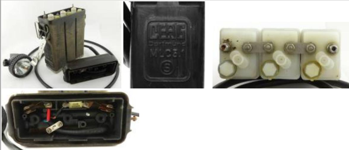
Akku: NiCd (dreizellig) 3,90 V, Glühlampe: 3,75 V, 1,0/0,5 A, Ladespannung 5,1V, 14 Ah, Höhe: 194mm, Breite: 133mm, Tiefe: 54mm, Gewicht: 2300 gr.
