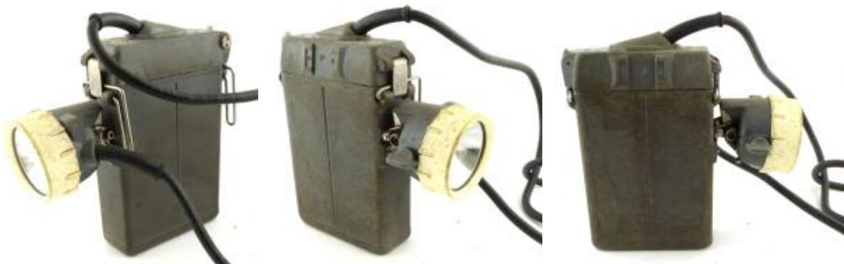
Akku: NiCd (zweizellig) 2,6 V, Glühlampe: 2,5 V, 1,0/0,5 A, 14 Ah, Ladespannung 3,4V, Höhe: 179mm, Breite: 115mm, Tiefe: 45mm, Gewicht: 1785 gr.
