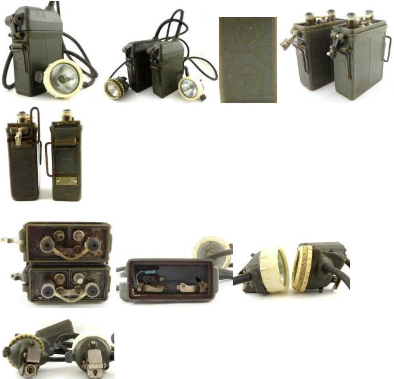
FRIWO-Kopfstücke: Das neuere Kopfstück ist mit dem breiteren weißen Rand und den größeren Schalter versehen. Akku: NiCd (zweizellig) 2,6 V, Glühlampe: 2,5 V, 1,0/0,5 A, Höhe: 171mm, Breite: 115mm, Tiefe: 49mm, Gewicht: 1910 gr.
