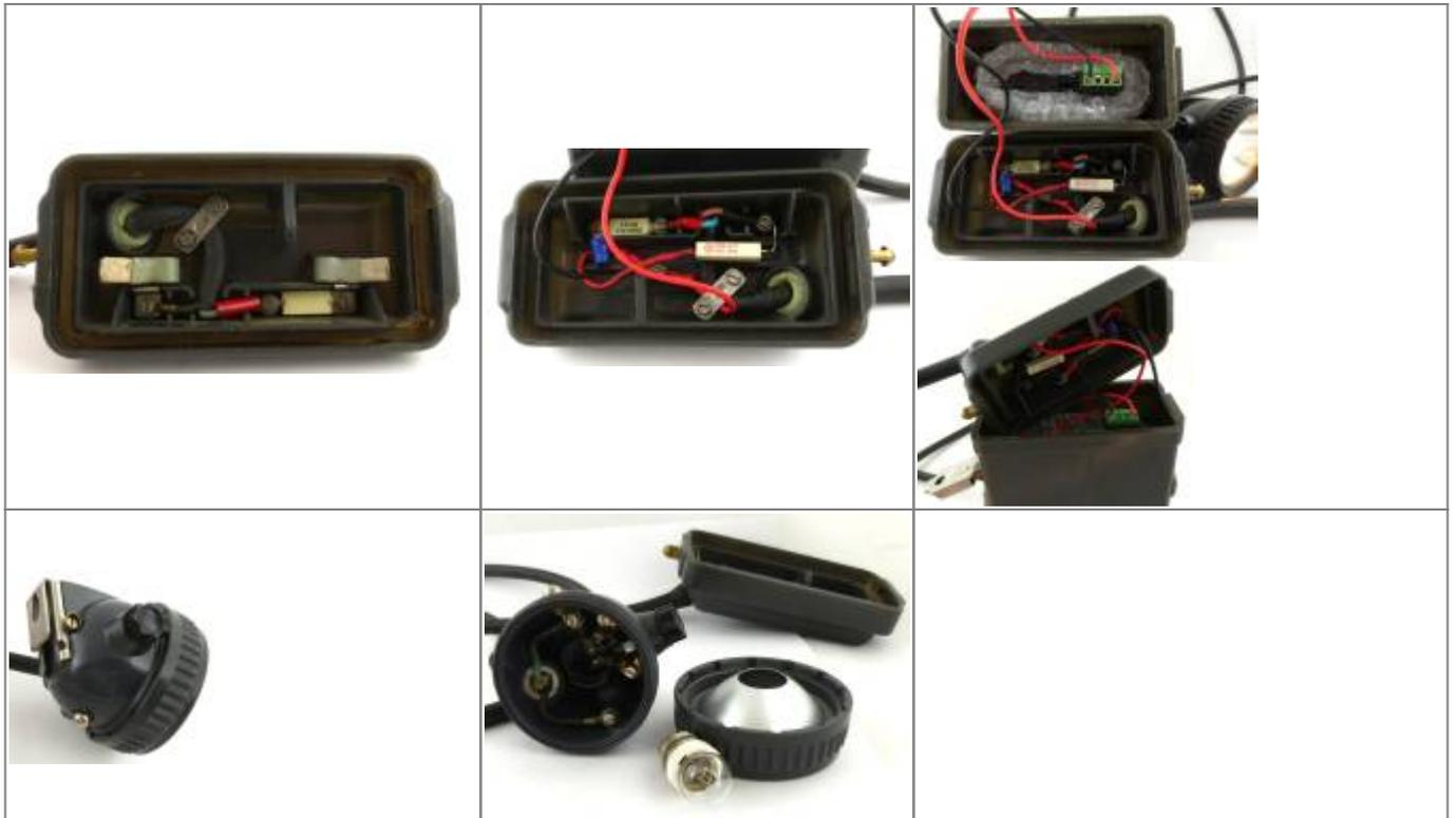
Für den einfachen Umbau mit einer Powerbank als Energiequelle ist hier ein Keramik-Widerstand mit 1,5 Ohm (10W) eingebaut worden. Dadurch reduziert sich die Spannung von 5 Volt auf 3,5 Volt. [Materialliste](#)
