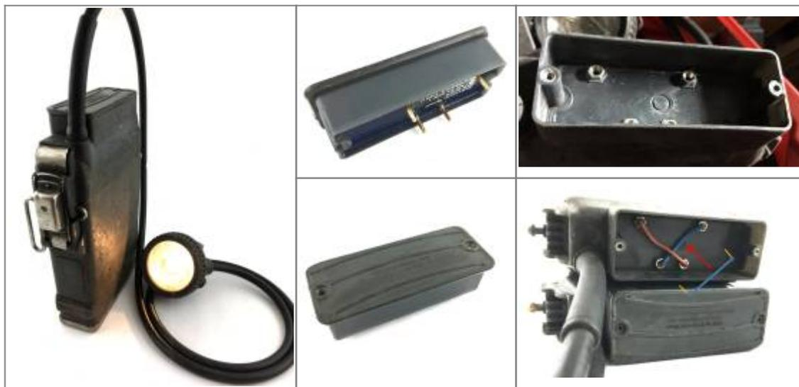
Problem 2: Im Inneren der CEAG 9.2 befindet sich der Nickel-Cadmium-Nasszellenakkumulator, der die Energie für die Kopfleuchte und den Personenkennbaustein liefert. Auch im Ruhezustand verbraucht der Personenkennbaustein Energie und **entlädt bei längerem Nichtgebrauch** den Akku. Durch entfernen einer Schraube im Kopfteil soll dies angeblich verhindert werden (Noch in der Testphase!). Hier schon mal zum Ausprobieren eine Anleitung.
