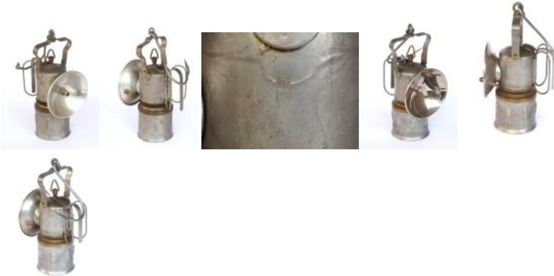
**Modell 124:** zunächst großer zweischalig-einteiliger, angeschraubter Parabolreflektor, später zweiteilig-einschaliger Parabolreflektor, dreieckiger, klappbarer Wasserspindelgriff, Rückenhaken und hintere Handgriffe, Karbidbehälter mit 7 Rippen 1939-1950
