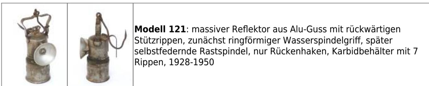
**Modell 121:** massiver Reflektor aus Alu-Guss mit rückwärtigen Stützrippen, zunächst ringförmiger Wasserspindelgriff, später selbstfedernde Rastspindel, nur Rückenhaken, Karbidbehälter mit 7 Rippen, 1928-1950
