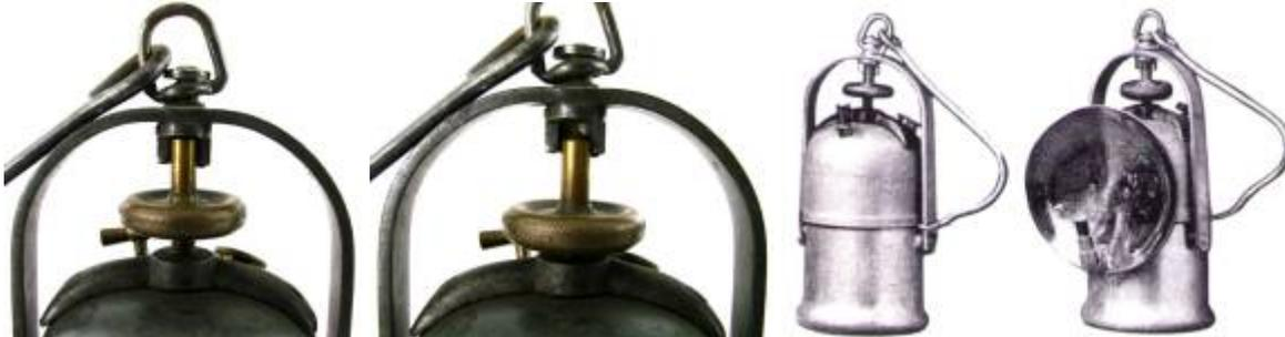
Josef Brumberg (Sundern / Sauerland) baute bis in die 50er Jahre des letzten Jahrhunderts Grubenlampen. Im Wassertank ist eine eingelötete Gewindehülse. Darin befindet sich eine Gewindestange die gegen den Tragbügel drückt und so den Wasserbehälter gegen den Karbidtopf abdichtet. Die Katalogabbildung zeigt das Modell II mit einfacher Druckplatte das nach 1922 gebaut wurde.
