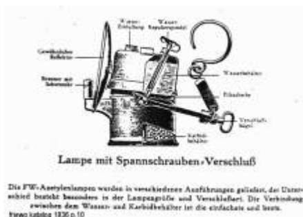
Spanschrauben-Bügelverschluss mit gegossenem Druckbügel. Ursprünglich von Friemann&Wolf wurde dieser Lampentyp auch von anderen Herstellern produziert bzw. verkauft (JORIS, SEMOI, Wolf-Leeds). Die Wasserspindelschraube befindet sich auf der vorderen Seite des Wassertankbehälters.
