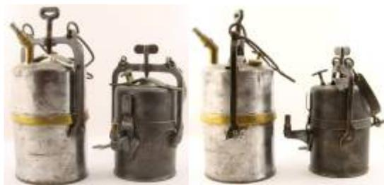
Mit der typischen Wasserspindelschraube von Joris ausgestattet wurde diese Lampe mit einem Messing-Firmenschild „FL = Fabrique Liégeoise“ ausgestattet.
