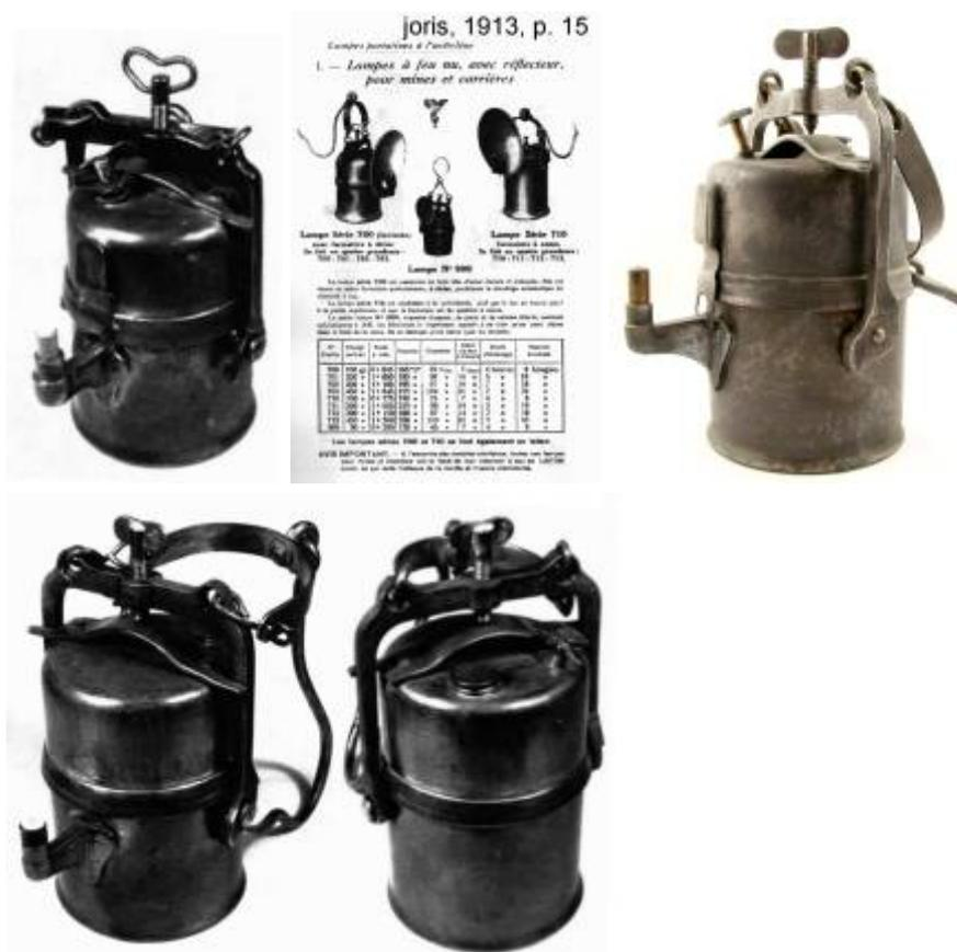
Bemerkenswert ist die Aufnahme rechts. Sie zeigt eine Joris-Lampe, bei der die Wasser-Regulier-Spindel und der Wassertankdecken auf der rückwärtigen Seite des Wassertankbehälters liegen. Weil es hierbei Schwierigkeiten beim Auseinanderschrauben der Lampe gegeben haben muss, ist mir bis jetzt kein einziges Exemplar dieser Baureihe bekannt. (Quelle:H.J. Weinberg, Die Grubenlampe - Von Zwickau um die ganze Welt, Seite 84, Göttingen 1998, Usines H.Joris, um 1930
