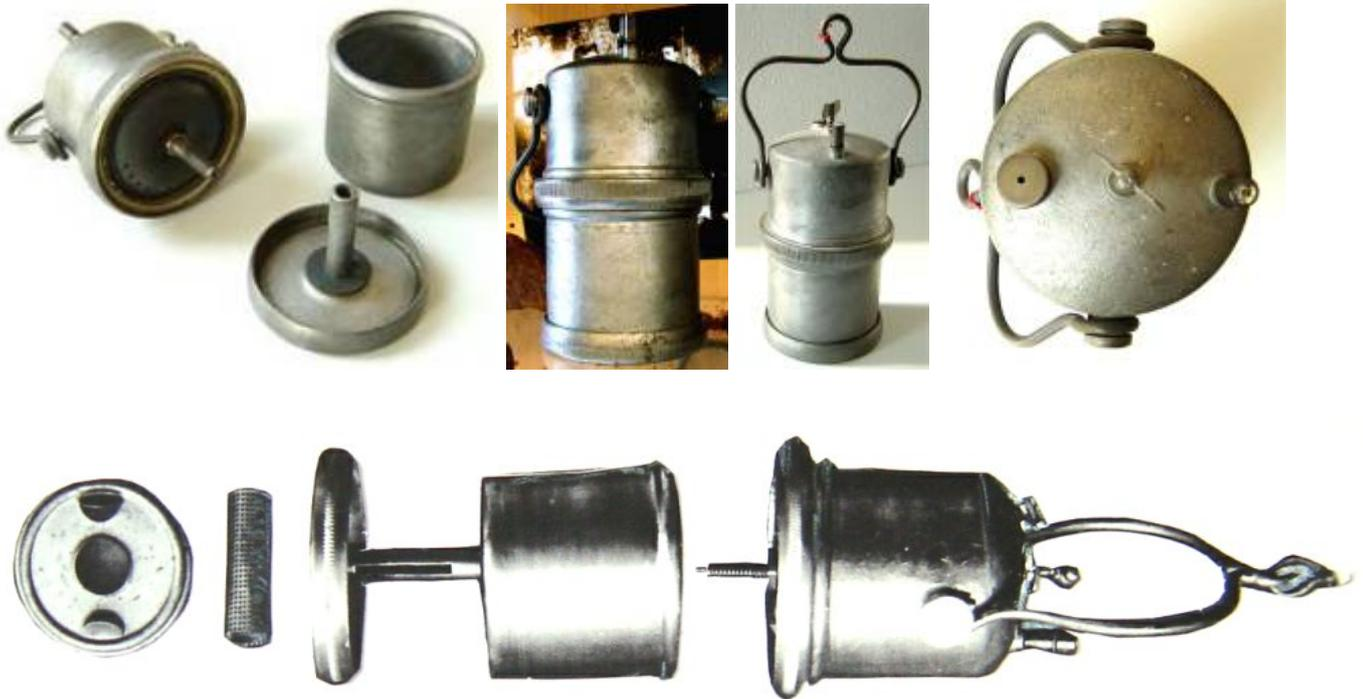
Diese gut konzipierten Excelsior-Lampen hatten einen Nachteil. Die Zentralschraube lies sich durch die Oxidation und Verschmutzung schwer öffnen. Darum entwickelte Pierre Schiltz (1912) die erste Karbidlampe mit Exenter-Verschluss, das Modell „Simplex“.
