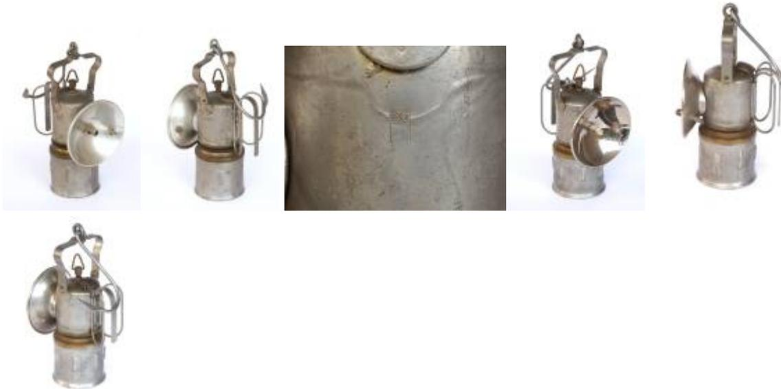
**Modell 124:** zunächst großer zweisehalig-einteiliger, angeschraubter Parabolreflektor, später zweiteilig-einschaliger Parabolreflektor, dreieckiger, klappbarer Wasserspindelgriff, Rückenhooken und hintere Handgriffe, Karbidbehälter mit 7 Rippen 1939-1950
