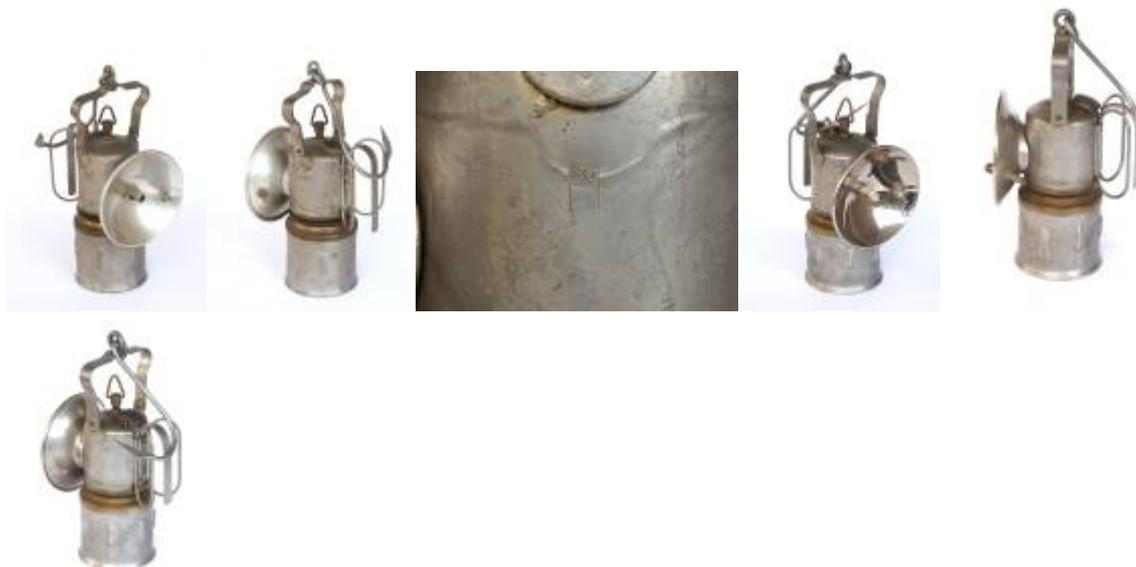
**Modell 124:** zunächst großer zweischalig-einteiliger, angeschraubter Parabolreflektor, später zweiteilig-einschaliger Parabolreflektor, dreieckiger, klappbarer Wasserspindelgriff, Rückenhooken und hintere Handgriffe, Karbidbehälter mit 7 Rippen 1939-1950
