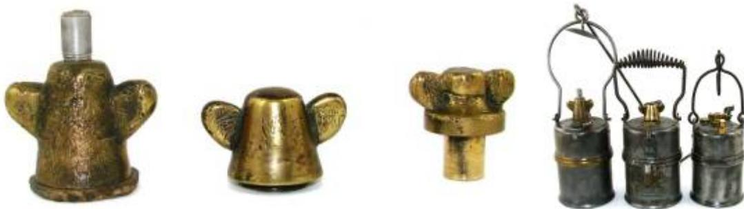
Flügelmutter als Brennerträger und die geschlossene Flügelmutter.
