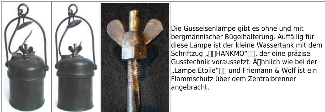
Die Lampe wiegt etwa 2,8 kg bei 10 cm Durchmesser und einer Höhe von 14 cm. Über die Nut in der Halteschraube gelangt das Acetylen gas in den Brenner. Bei den „Etoile-Lampen“ gelangt das Acetylen gas über eine durchgehende Bohrung zum Brenner. In der Friemann & Wolf - Lampe ist an Stelle der Nut eine Mittelbohrung mit seitlicher Freibohrung zu sehen.
