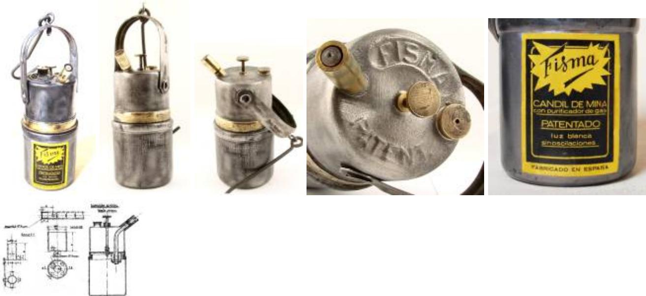
Die Bauteile der Lampe sind aus sehr dünnem Eisenblech-Material gedrückt. Die Schraubverstärkung, Wasserregulierspindel, Wasserbehälter-Deckel und Brennerträger sind aus Messing.
