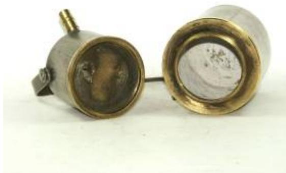
Auf der Oberseite befindet sich eine Punze mit der kaum noch lesbaren Herstellerangabe, darunter „SOME“ de acero embutido (= aus tiefgezogenen Stahl). Die Lampe hat eine Höhe von 18,2 cm und einen Bodendurchmesser von 9,0 cm. Informationen und Bilder zu dieser Lampe sind von Hans-Joachim Weinberg.
