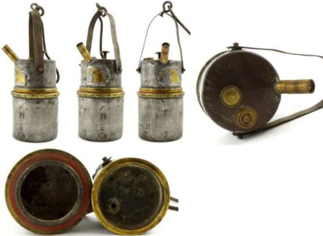
Unión Cerrajera (1940) Durchmesser Wasserbehälter oben 7 cm, Karbidbehälter unten 8 cm. Es sind auch Lampen mit einem durchgängigen Durchmesser von 7 cm bekannt.
