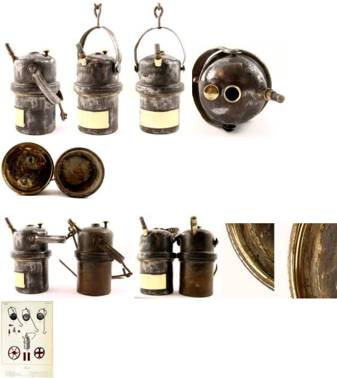
Die Firma Cerrajera Unión S.A. in Mondragon (Spanien) stellte diese kleine Schraub-Verschluss-Lampe, neben anderen Metallkonstruktionen, her. Das Aussengewinde am Karbidtopf wurde in Messing- oder Eisen ausgeführt. Interessant ist die Messing-Innen-Gewindeausführung im Wassertopf. Hier wurde ein Messing-Gewinde-Ring im gedrückten Eisentopf eingelötet. Die Lampe ist ausgezeichnet gearbeitet. Katalogblatt von 1936. (Höhe Lampentopf 150mm, Höhe Tragebügel 200mm, Durchmesser 77 mm, Baujahr ca. 1950)
