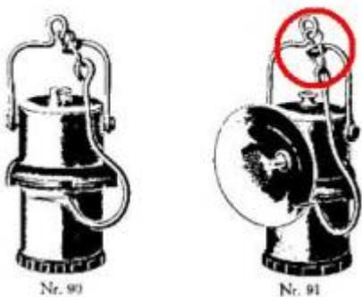
Unterschiedliche Ausführung der Verschlusshacken. Abbildungen von Butin, Hesse und Rötelmann. Rötelmann, Werdohl, kopierte die Schiltz-Lampe, Katalog L5 von 1920. Diese Lampe war auch ohne
