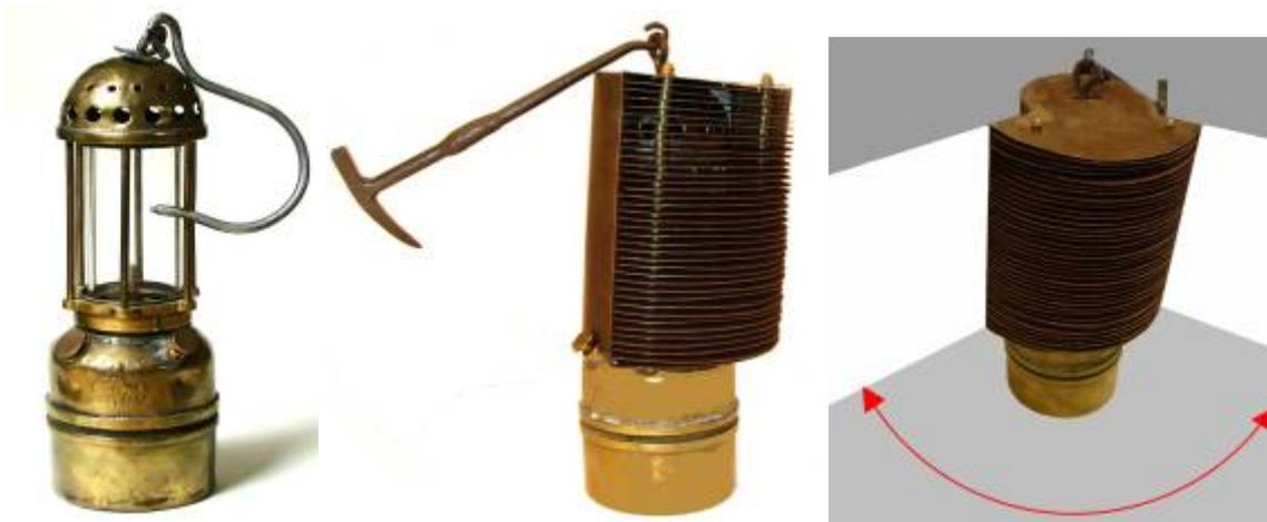
Hierbei handelt es sich um eine Carmaux-Lampe aus Messing der Firma ARRAS von 1915. „LAITON AVEC OCCULTEUR“ Messing mit Occulateur, wobei Occulateur mit „Verschatten“ und „Verdunkeln“ übersetzt werden kann. Über eine Carmauxlampe wird eine Messinghaube geschoben, die dann den Lichtkegel mit einem Winkel von 125 Grad austreten lässt. Somit können ausgewählte Stellen blendfrei für andere Bergleute beleuchtet werden. Durch aushängen des Tragehackens ist der Occulteur leicht zu entfernen.
