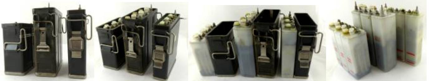
In Paris stellt 1891 Donato Tommasi seine "Konstruktion einer elektrischen Sicherheitslampe" vor. Mit der Verbesserung der Glühlampe durch einen gedrehten Daht (Drahtwendel) und die stetige Erweiterung der Akkuleistung wurden die elektrischen Akkulampen für den Bergbau interessant. Nach mehreren Grubenunglücken in den 1920iger Jahren wurden elektrische Grubenlampen (Pottlampen) in allen Schlagwettergruben (z.B. im Ruhrgebiet) eingeführt. Blitzler und Benzinwetterlampen benutzten die Steiger.
