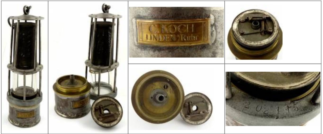
Wetterlampe von Carl Koch (Bochum-Lindener Zündwaren- und Wetterlampen-Fabrik, Linden(Bochum)), Feilenzünder, Magnalium-Schraubring.
