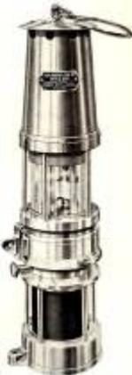
A Spiralarm „TYPE M“ was used for detecting explosive gas in the mine. The „TYPE S“ used in sewers. In der Lampe befand sich ein Bimetalkontakt. Dieser schloss, wenn er sich der Bimetalkontakt zu stark erhitzte (Gas) einen elektrischen Stromkreis. Dann leuchtete eine Batteriebetriebene Glühlampe im unteren Bereich der Lampe. Merkmal: kleines rotes Glas > M (mine) großes rotes Glas > S (sewers / Sanitär / Abwasserkanal)
